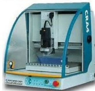
Par enlèvement de matière par fraisage avec le Charlyrobot.
