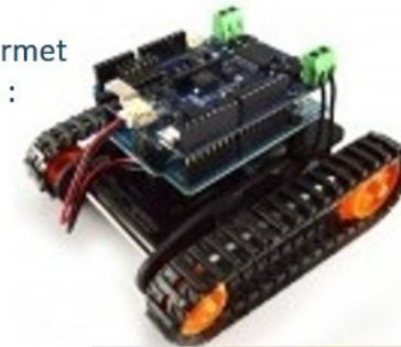
Par assemblage de cartes électroniques programmables (Arduino, Picaxe ...) et de différents capteurs et actionneurs.
