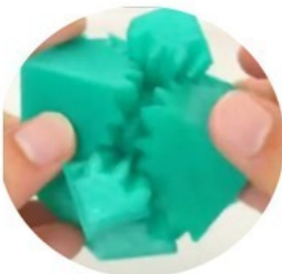
Par addition de matière avec une imprimante 3D.
